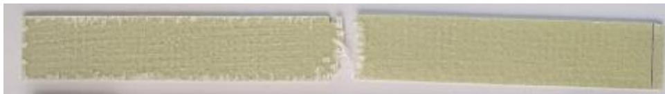
Şekil 4. Hasarlı çentikli deney numunesi
