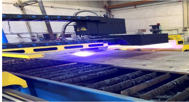
Görsel 1.1 : Hardox450 ve S700 sac plakaların plazma kesim tezgahında kesilmesi.
