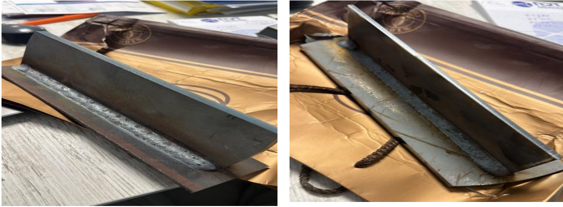
Görsel 1.3. S700 çeliğinin ve Hardox 450 çeliklerinin, robotik kaynak teknolojisiyle kaynaklı numuneleri.
