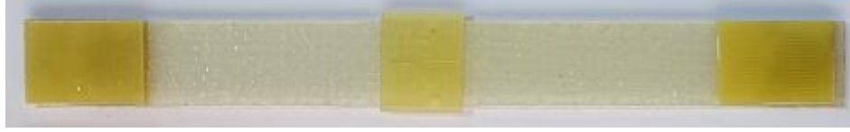
Şekil 2. Tek bindirme bağlantılı çentikli deney numunesi
