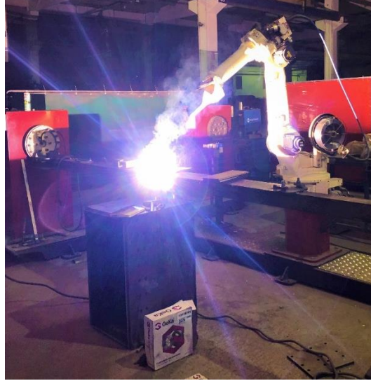
Görsel 1.2. Hardox450 ve S700 parçaların robotik kaynağı
