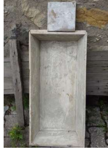
Görsel 21. Alçı sıva yapımında kullanılan tekne ve sıva küreği
